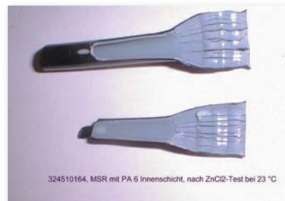
PA6では激しいストレスクラックが発生
